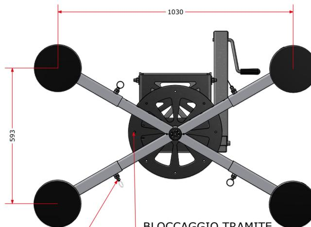
BLOCCAGGIO TRAMITE PERNO A SCATTO
